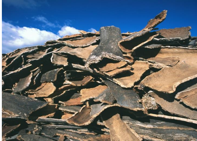
Fig. 3- Fase di stagionatura
